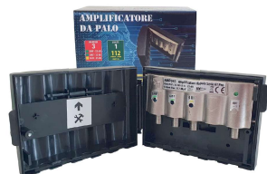
AMPLIFICATORE DA PALO 61 PRO 3 IN | 2 UHF 32dB + 1 BIII 25dB 1 OUT 112 dBμV cod. AMP041
