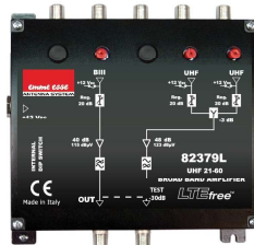
Centralino Larga Banda ingressi: 3 (BIII-UHF-UHF) guadagno: V/U40 / 45 dB livello uscita: 115 / 123 dBμV cod. 82379L
