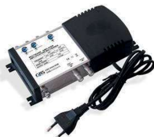
Centralino 3 Ingressi VHF, UHF, UHF attacco F 123dBuV | Guadagno: 40dB cod. 41973/LTE
