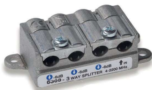
Mini Divisore passivo con diodi 4/2200MHz + CC 3 OUT cod. TW-6303
