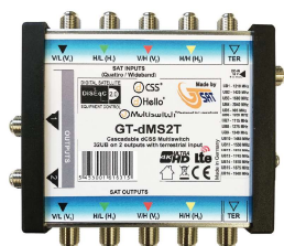
Multiswitch dCSS ibrido 2 OUT - 16UB 5 ingressi 2 uscite automatico univ./SCR/dCSS cod. GT-DMS2T
