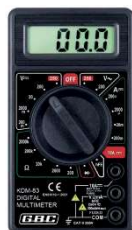
Multimetro Display LCD a 3 1/2 cifre 12,5mm cod. 50100015/E
