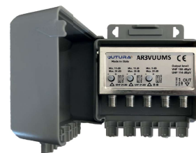
AMPLIFICATORE VHF-UHF 2 UHF = 30dB reg. VHF = 20dB reg. 1 OUT = 108-114dBμV cod. AR3VUUMS
